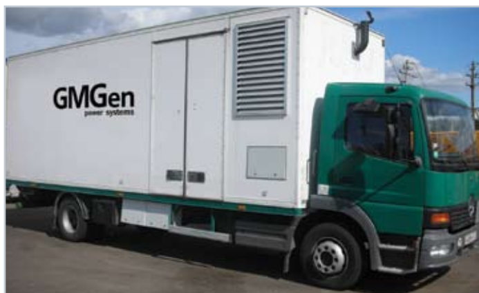
Дизель-генераторная установка в автомобиле
