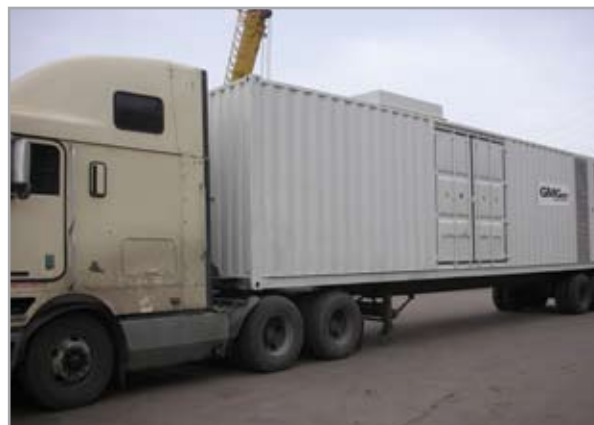
Дизель-генераторная установка в контейнере 12м
